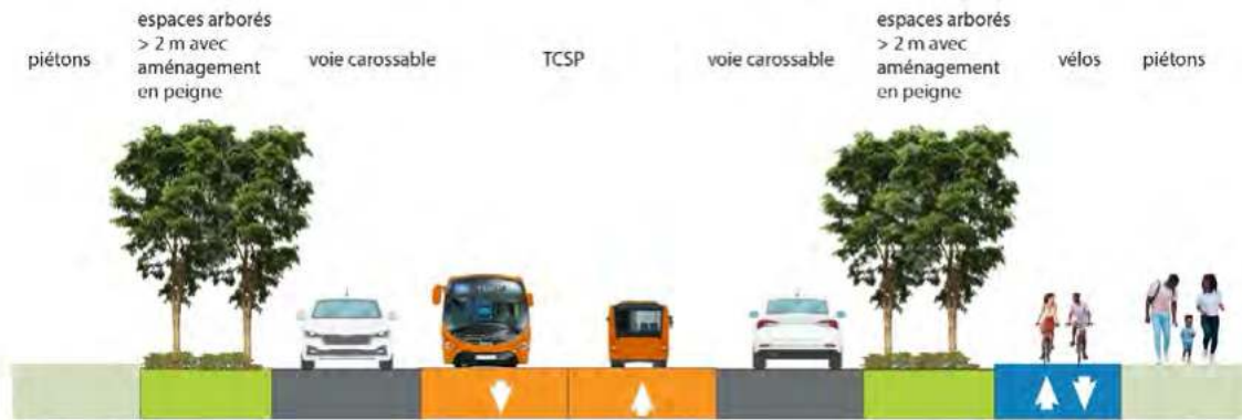
Figure 12 : Coupe type – Insertion Boulevard urbain (Source : Egis)
